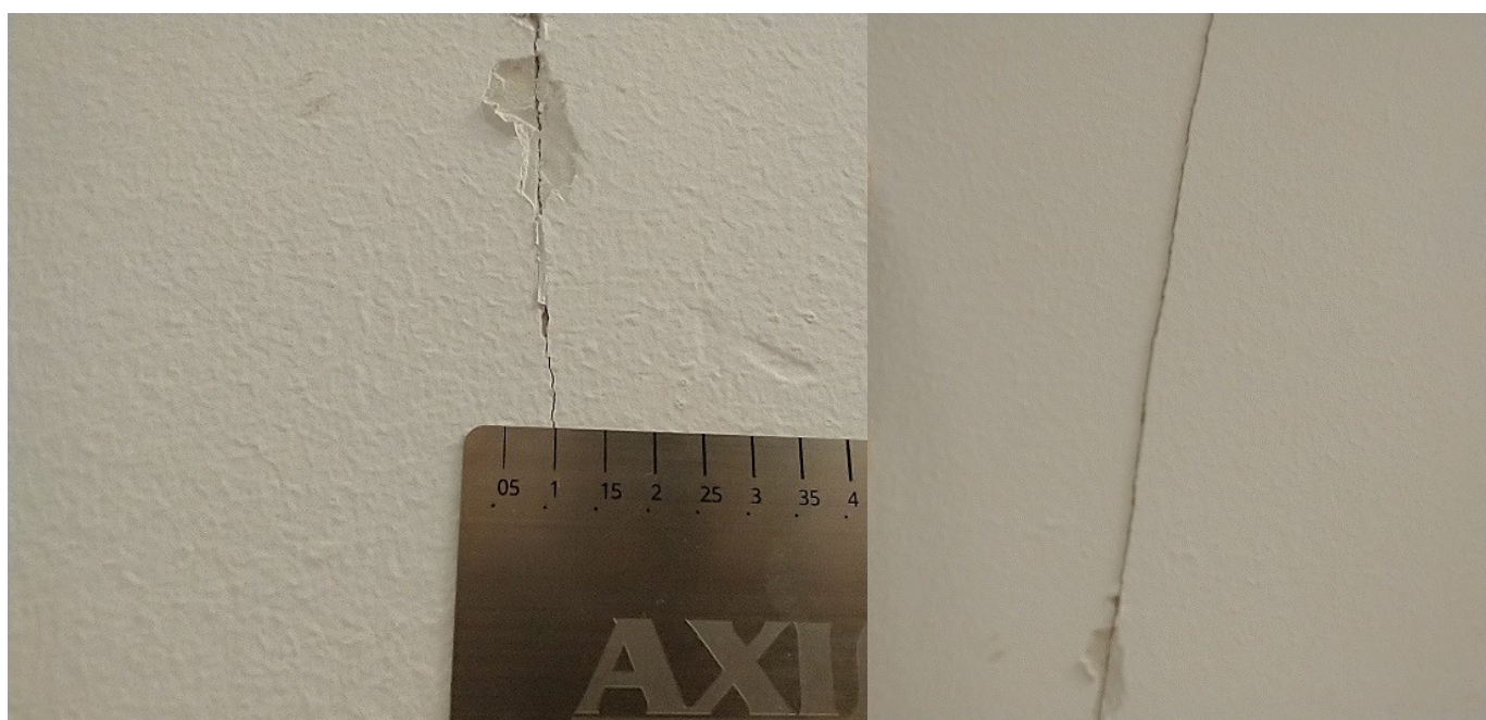
fot. 14. Pomiar szerokości rysy na suficie poddasza, widoczna nieprawidłowa obróbka styku.
